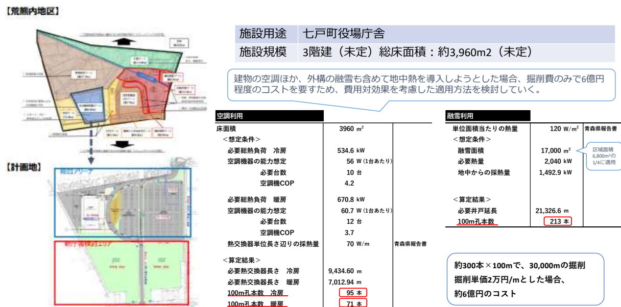
図 4-15 役場庁舎で地中熱を利用するためのボーリング費用の試算結果
